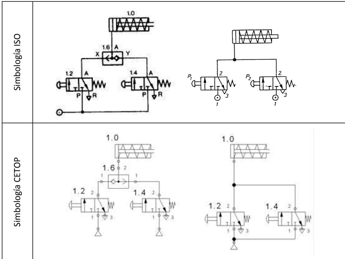
Al actuar sobre el pulsador de cualquiera de las dos válvulas 1.2, o 1.4, conseguimos que ésta cambie de posición, con lo que el aire comprimido circulará de P hacia A, y este aire comprimido llegará a cualquiera de las dos entradas X e Y de la válvula selectora 1.6, accediendo a la cámara del cilindro, actuando contra el resorte de su interior y provocando la salida de éste.
