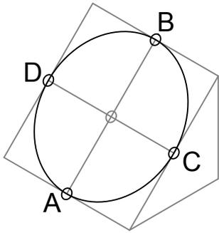
Dado el sistema cónico determinado por el PC, el PG, el PH, la LT, la LH, el punto de vista V abatido sobre el PC; y el abatimiento de una circunferencia oblicua al PC y al PG (45°), y tangente al PG, de diámetros AB y CD (elipse inscrita en un cuadrilátero rectángulo).
