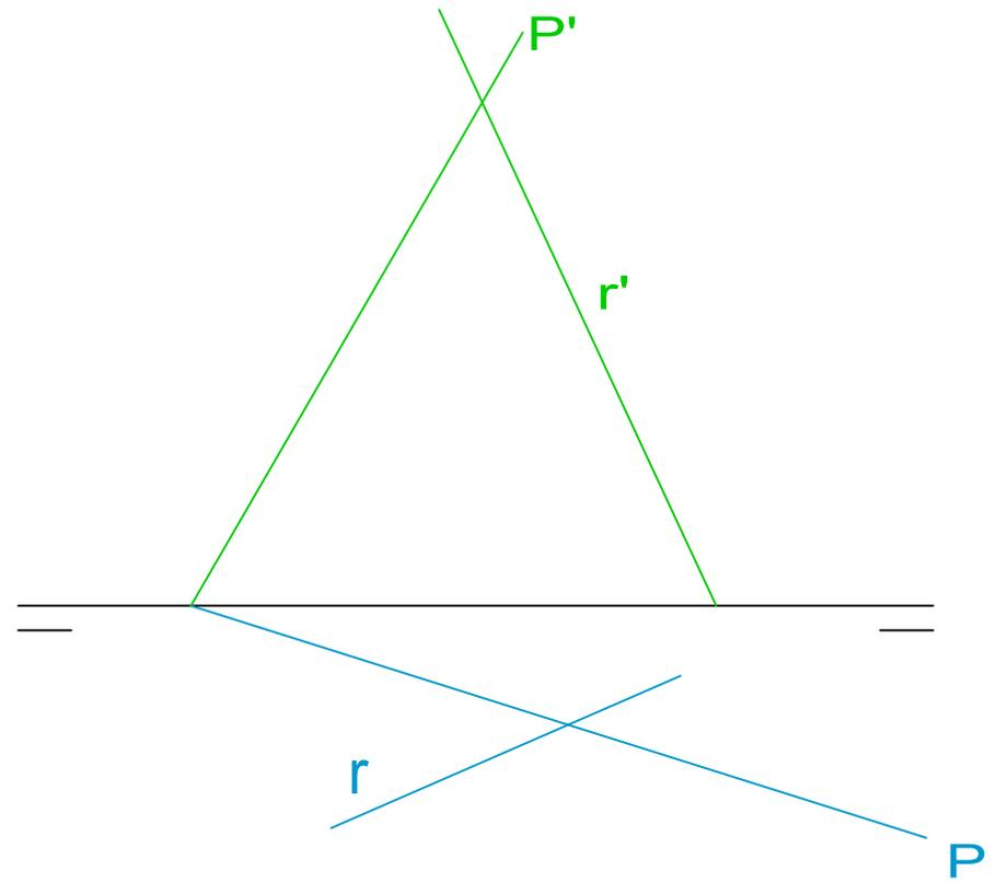
Dadas las trazas de un plano  $P$  y las proyecciones diédricas de la recta  $R$ , vamos a determinar su intersección  $I$ .
